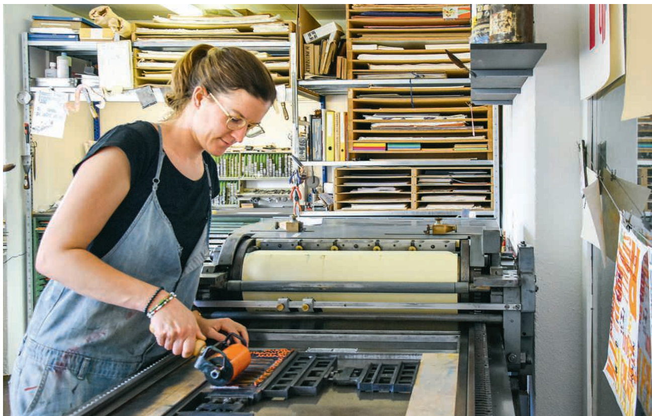
Vorbereitungen auf der Hochdruckmaschine: Rebecca Froelich trägt Farbe auf die Buchstaben auf, bevor sie mit der Walze darüberfährt und das eingespannte Papier bedruckt
