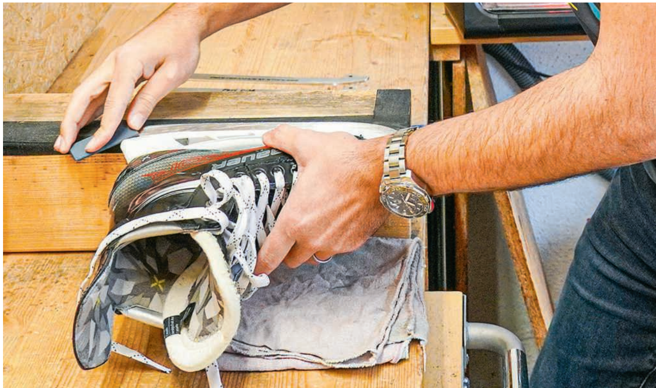
Nach dem Schliff in der halb automatischen Maschine wird das Eisen von Hand nachbearbeitet. Ein Handwerk, das erlernt sein will
