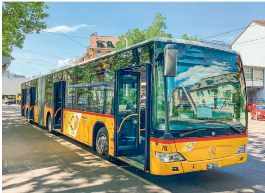
Was diesem Postauto fehlt, ist eine Haltekante, die 22 Zentimeter hoch ist und so Rollstuhlfahrenden einen ebenerdigen Zugang ermöglicht. Ein Komfort, den alle anderen Fahrgäste ebenfalls schätzen
