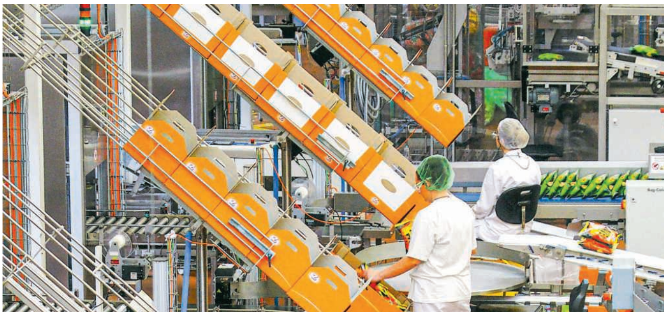
Heute: In grossen Behältern – je nach Gewürzmischung – warten die Chips darauf, verpackt zu werden. Das geschieht vollautomatisch. Die fertigen Beutel kommen in Wellkartonschachteln
